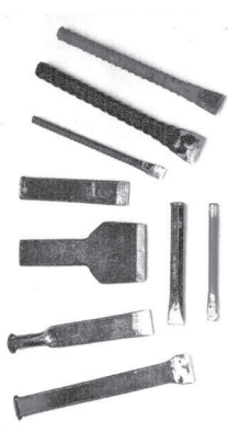
CINZÉIS CHATOS OU TALHADEIRAS - ferramentas de aço para acabamento.
