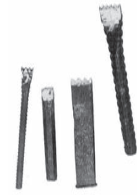
CINZEL DENTADO - limpeza de superfícies e formas, ou ainda, impressão de textura nas superfícies trabalhadas
