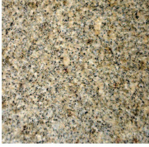
IMAGEM I.27: Enquadramento da pedra utilizada nas colunas dos alpendres do Mosteiro de São Bento - Centro/ RJ
