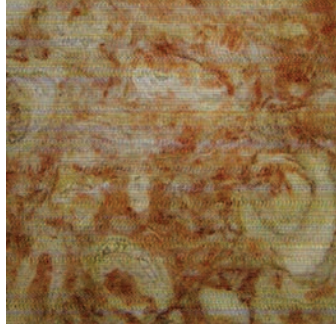
IMAGEM III.15: Lioz cortado a favor (corte paralelo ao sentido da deposição das camadas). Fonte: SILVA, 2007.
